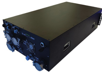
背面：一次/二次侧接口、RS-485、漏检、电源
